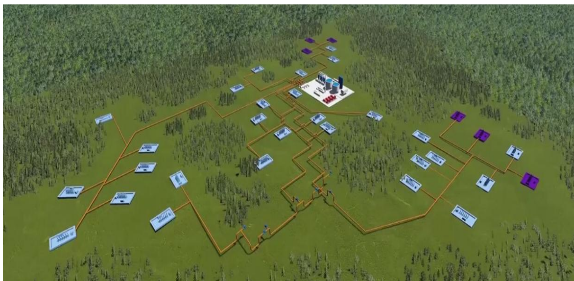
Рисунок 1. Схема транспортировки. Нефтепромысловые трубопроводы Новогоднего месторождения
