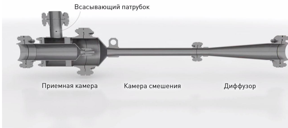
Рисунок 2. Конструкция эжекторного устройства
