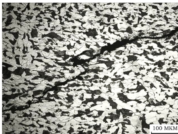
Рисунок 7 – Характер распространения трещины в металле \times 100
