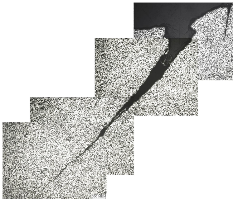
Рисунок 6 – Трещина в структуре металла \times 25
