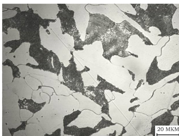
Рисунок 5 – Микроструктура металла тарелкодержателя на удалении от повреждения \times 500
