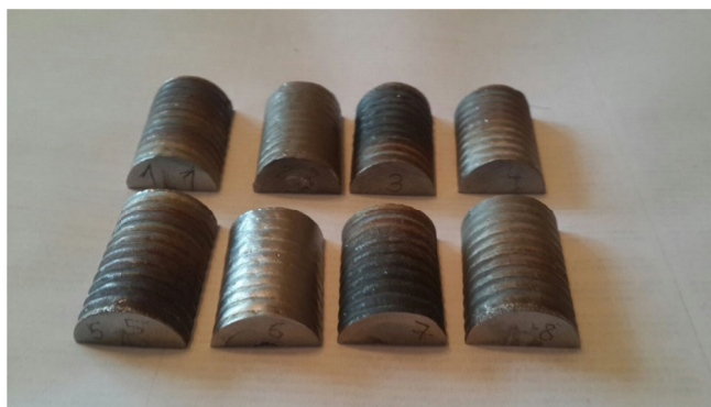
Рисунок 1 – Заготовки металлографических шлифов
