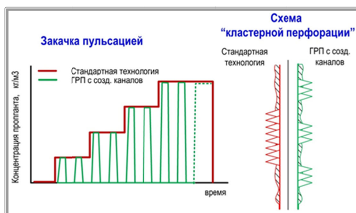
Рисунок 2 – Процесс создания каналов при проведении ГРП по технологии HiWAY
