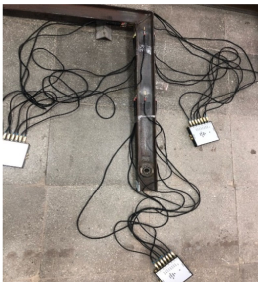
Рисунок 5 – Подключение тензодатчиков к адаптерам
