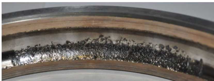
Рисунок 1 – Выкрашивание на дорожке качения наружного кольца
