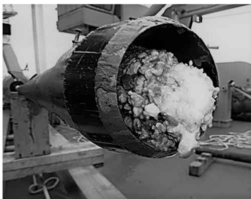
Рисунок 1 – Гидратообразование в буровой трубе
