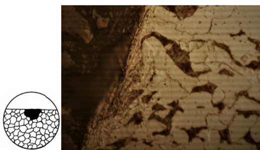
Рисунок 1 – Микроструктура стали 09Г2С на поверхности, контактирующей с коррозионной средой, \times 500 . Коррозионная язва. Коррозионное поражение глубиной приблизительно равной ширине
