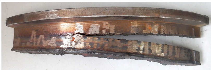
Рисунок 1 – Общий вид повреждения фланца
