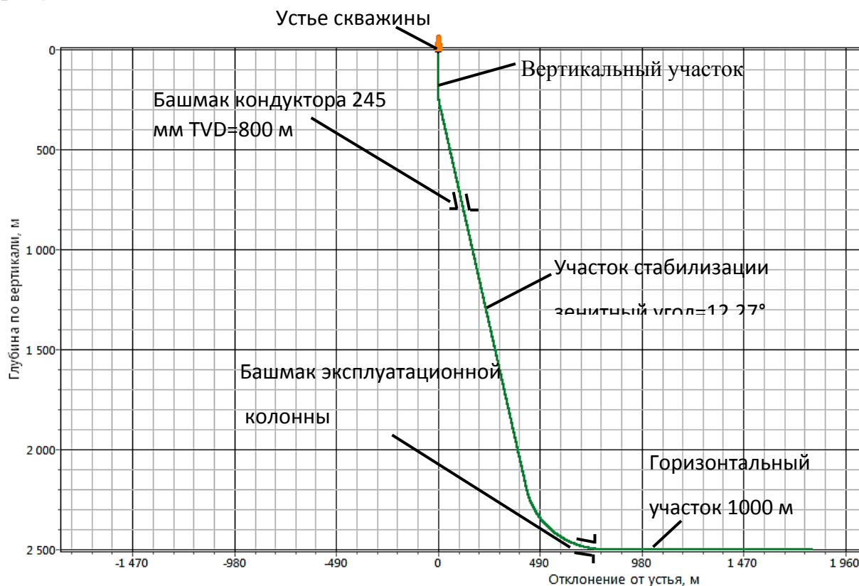
Рисунок 1 — Проектный профиль горизонтальной скважины
