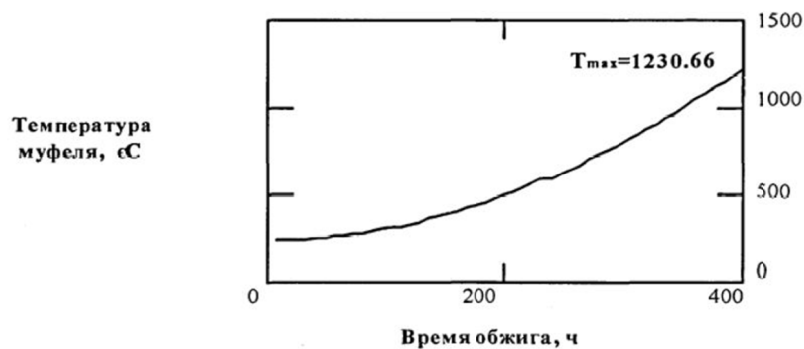
Рисунок 1 – Расчетная зависимость изменения температуры муфеля от времени обжига
