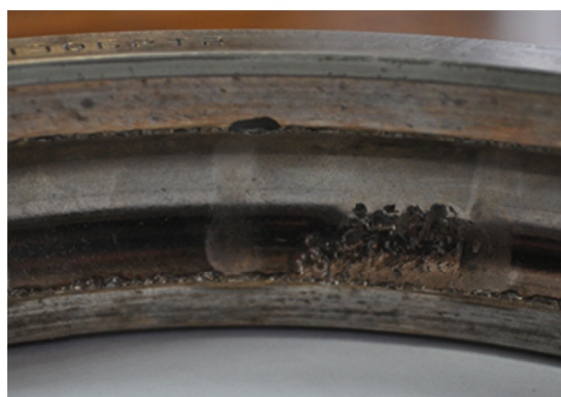
Рисунок 2 – Скол на кромке в месте перехода дорожки качения к бортику
