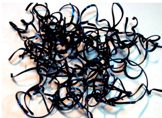
Рисунок 1 – Стружка сливная без завитков
