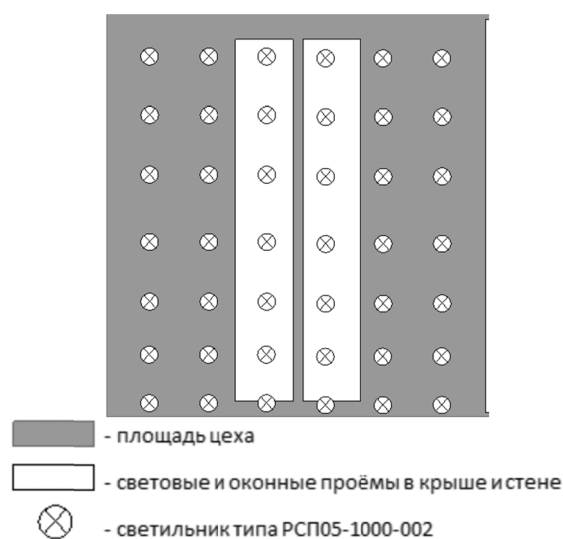
Рисунок 1 – Схема размещения светильников основного освещения в цеху
