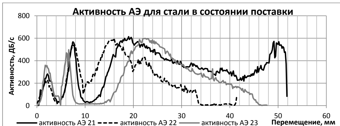
Рисунок 1 – Зависимость активности акустической эмиссии в ДБ/с от абсолютного удлинения в мм, для стали в состоянии поставки.
