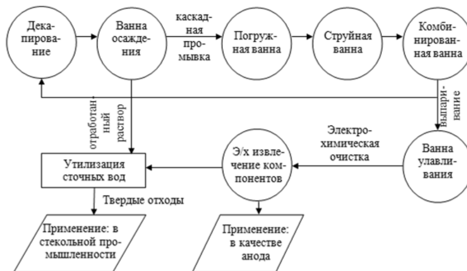
Рисунок 1 - Схема процесса хромирования
