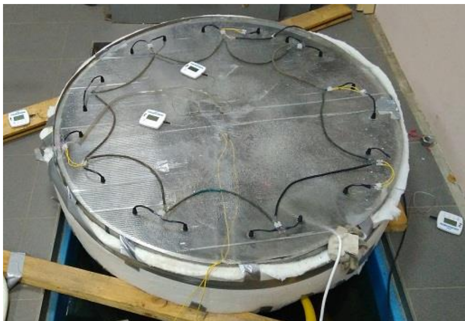
Рисунок 2 – Имитационный стенд погруженный в охлаждающую среду (фотофиксация)
