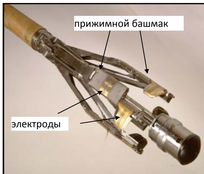
Рисунок 1. Пластовый электрический микросканер ( FMI )
