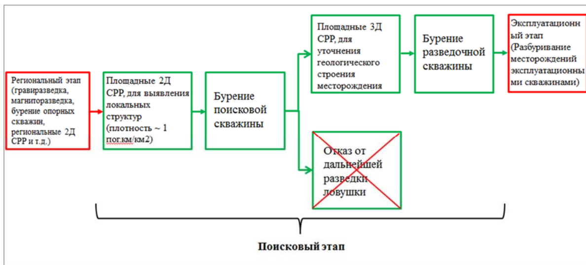
Рисунок 1. Схема стандартной программы ГРП для меловых отложений
