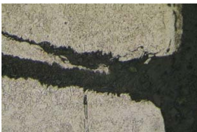
Фото 8 – Очаг разрушения шпильки, \times 200
