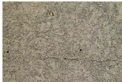
Фото 11 – Сульфиды и нитриды в металле шпильки
