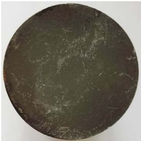
Фото 3 – Поверхность излома шпильки №7
