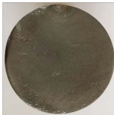
Фото 2 – Поверхность излома шпильки №6
