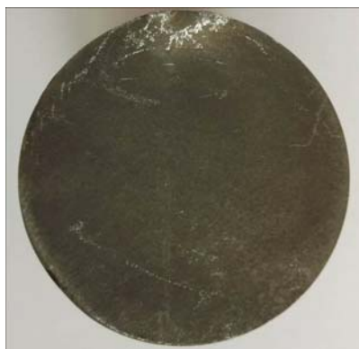
Фото 1 – Поверхность излома шпильки №5
