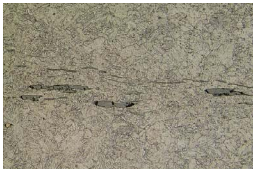
Фото 10 – Сульфиды в металле шпильки
