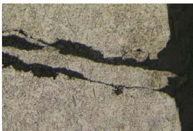
Фото 6 – Очаг разрушения шпильки, \times 200
