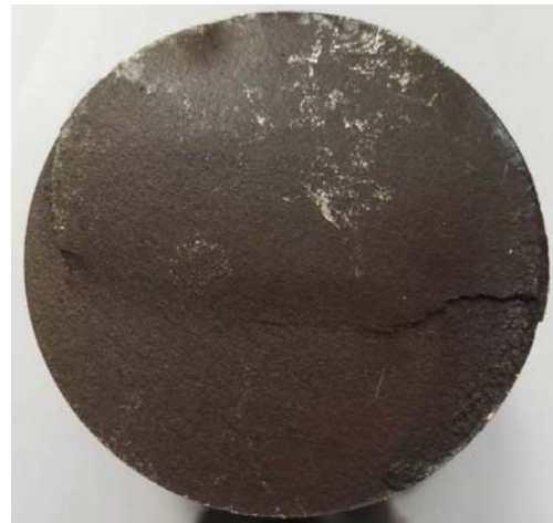
Фото 4 – Ответная поверхность излома шпильки №7 с очаговыми ступеньками при слиянии усталостных трещин в одну магистральную
