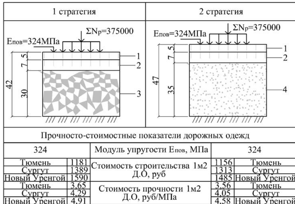
Рисунок 2. Конструктивные схемы дорожных одежд рассматриваемых стратегий и их прочностно-стоимостные показатели
