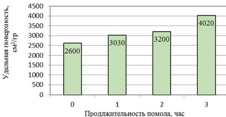
Рисунок 1. Величина удельной поверхности проб молотой золы с различной продолжительностью помола
