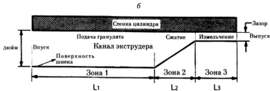
Рисунок 1. Схема одношнекового экструдера для измельчения резины (а); геометрия фрагмента канала шнека с переменной глубиной нарезки (б)
