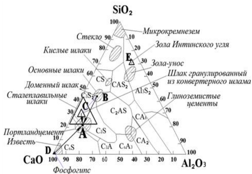
Рисунок 1. Диаграмма фазового состава CaO-Al 2 O 3 -SiO 2 по расчетным значениям, области традиционных вяжущих, приведены на основе данных Ранкина
