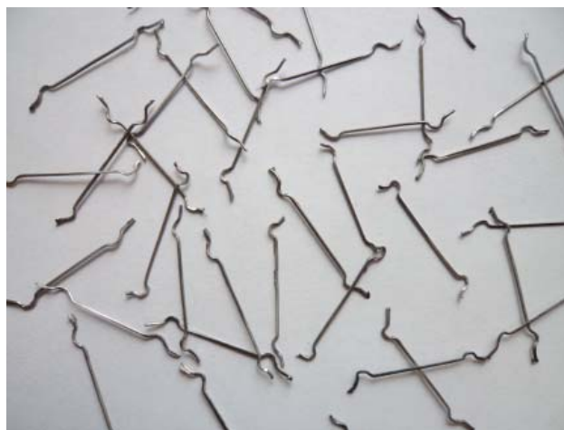
Рисунок 1. Фибра фрезерованная из стального листа
