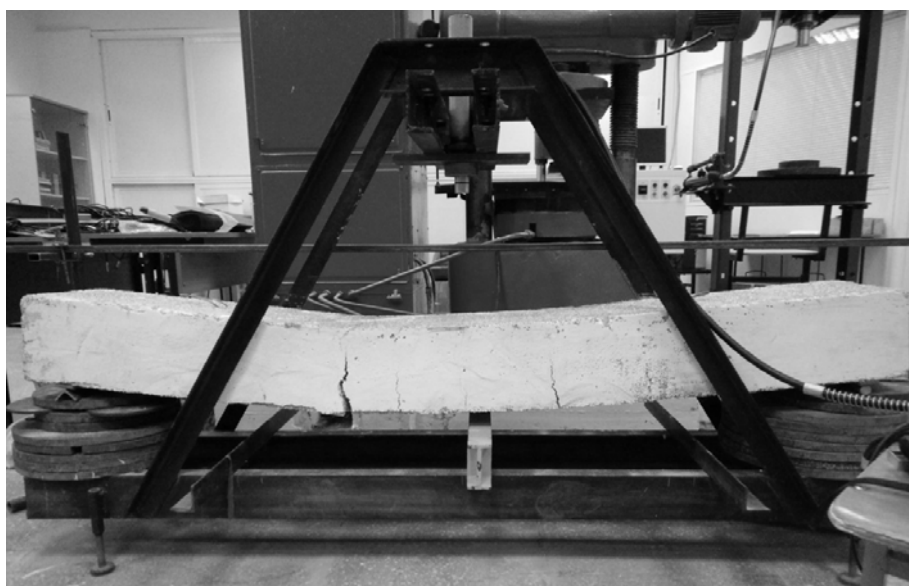
Рисунок 3. Разрушение перемычки из полистиролбетона при испытании
