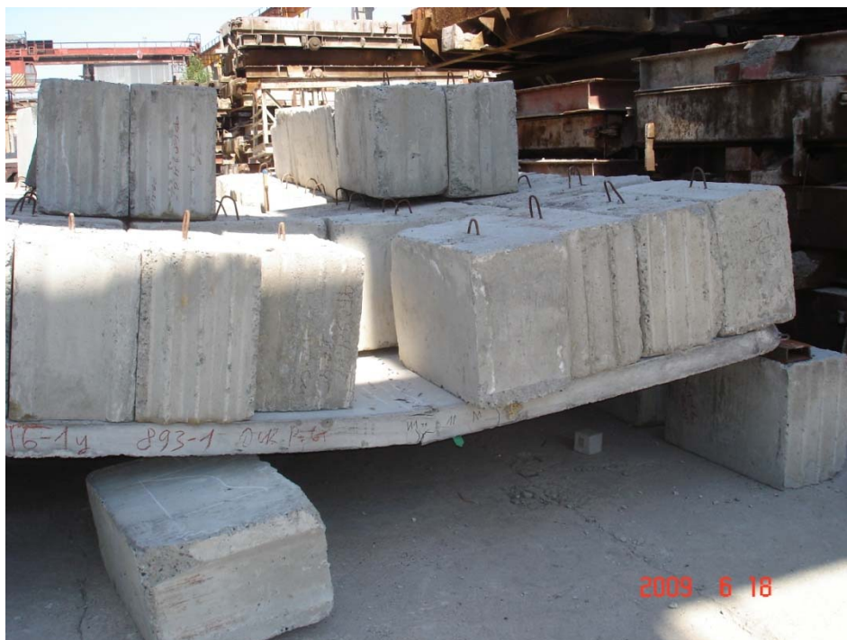
Рисунок 1. Фрагмент испытаний плиты перекрытия П6-1. Разрушение в середине пролета свободной грани плиты [1]
