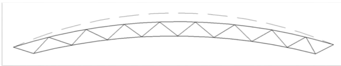
Рисунок 2. Структура с параллельными по радиусу поясами
