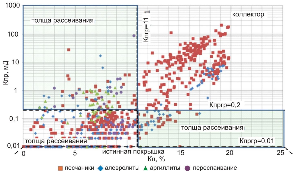
Рисунок 11 - График зависимости K_{п}/K_{пр} для пластов БУ 16-20
