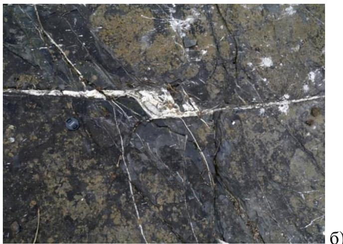
Рисунок 21 – а) Скаполит-амфиболовый парасланец темно-серой до черной окраски сланцеватой текстуры. Трещины сдвигового типа, расположенные под углом  $45^0$  к оси керна (по материалам ТО «СургутНИПИнефть»)
