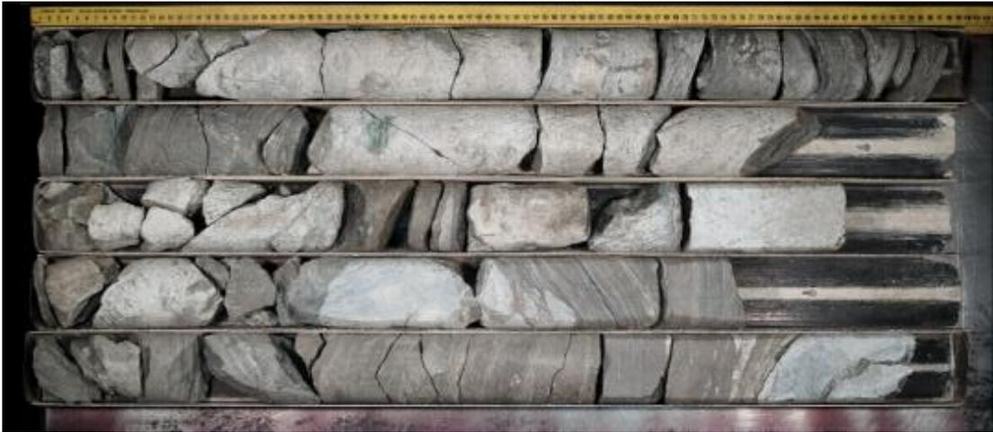
Рисунок 18 – Метаморфическая порода, представленная биотитовыми и двуслюдяными кварцевыми сланцами (по материалам ТО «СургутНИПИнефть»)
