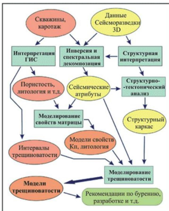
Рисунок 46 – Последовательность работ при моделировании трещиноватости [16]
