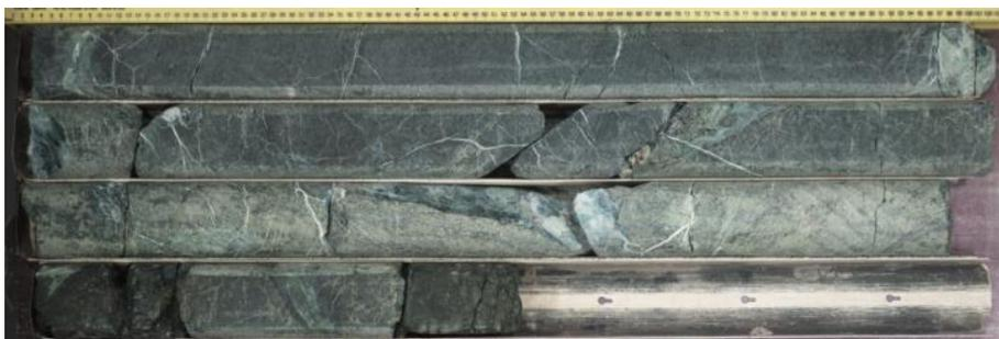
Рисунок 17 – Серпентинит темно-зеленой окраски трещиноватый, брекчиевидной текстуры. Трещины разнонаправленные, под углами 70-80° к оси керна (по материалам ТО «СургутНИПИнефть»)
