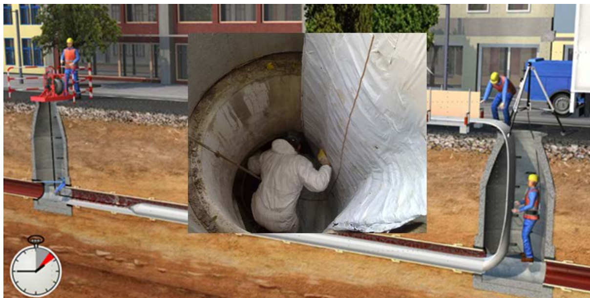
Рисунок 3. Метод введения полимерного рукава
