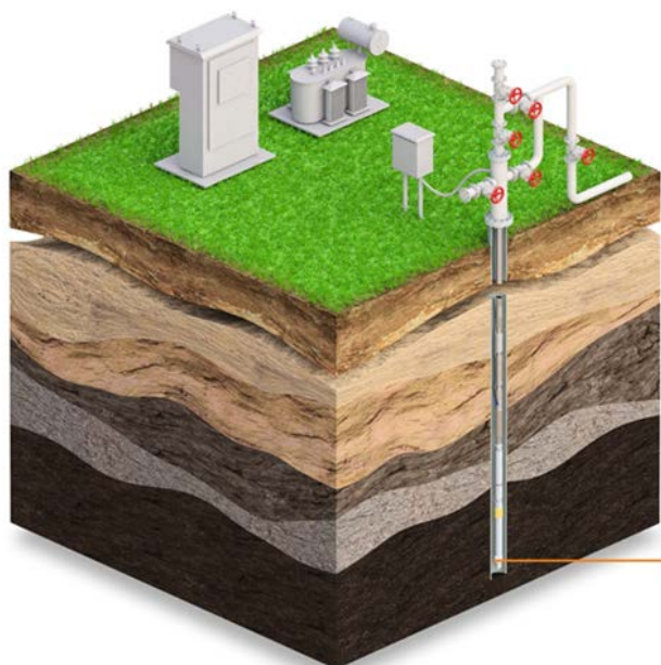
Рисунок 2. Расположение прибора УЗО работающего с ЭЦН
