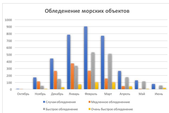
Рисунок 1. Более 3500 случаев брызгового обледенения зафиксировано за 2017 год.
