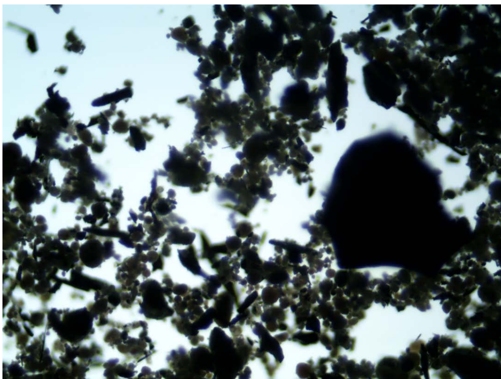
Рисунок 1. Частицы микросилики под микроскопом
