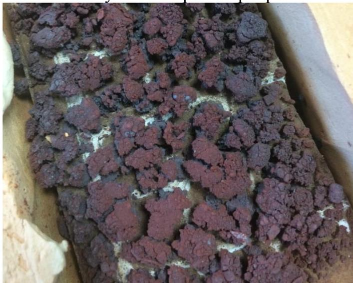
Рисунок 1 – Восстановленный агломерированный осадок
