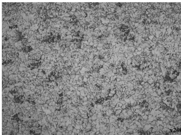
Рисунок 2 – Основной металл в поперечном направлении (зона 1, *a*)
