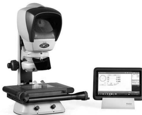
Рисунок 2 – Микроскоп Vision Engineering
