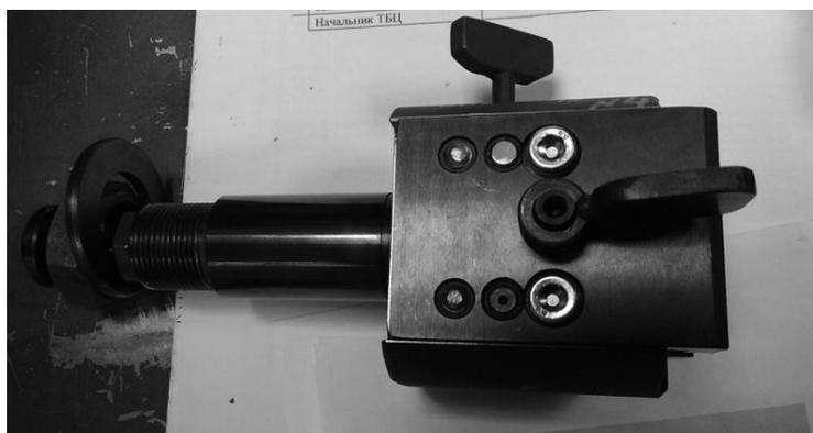
Рисунок 2 – Переходник на прибор для контроля профиля пера лопаток
