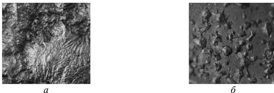
Рисунок 2 – Микрофотографии композиционных покрытий, содержащих 5 (а) и 10 масс. % (б) ТРГ после проверки на огнеупорность
