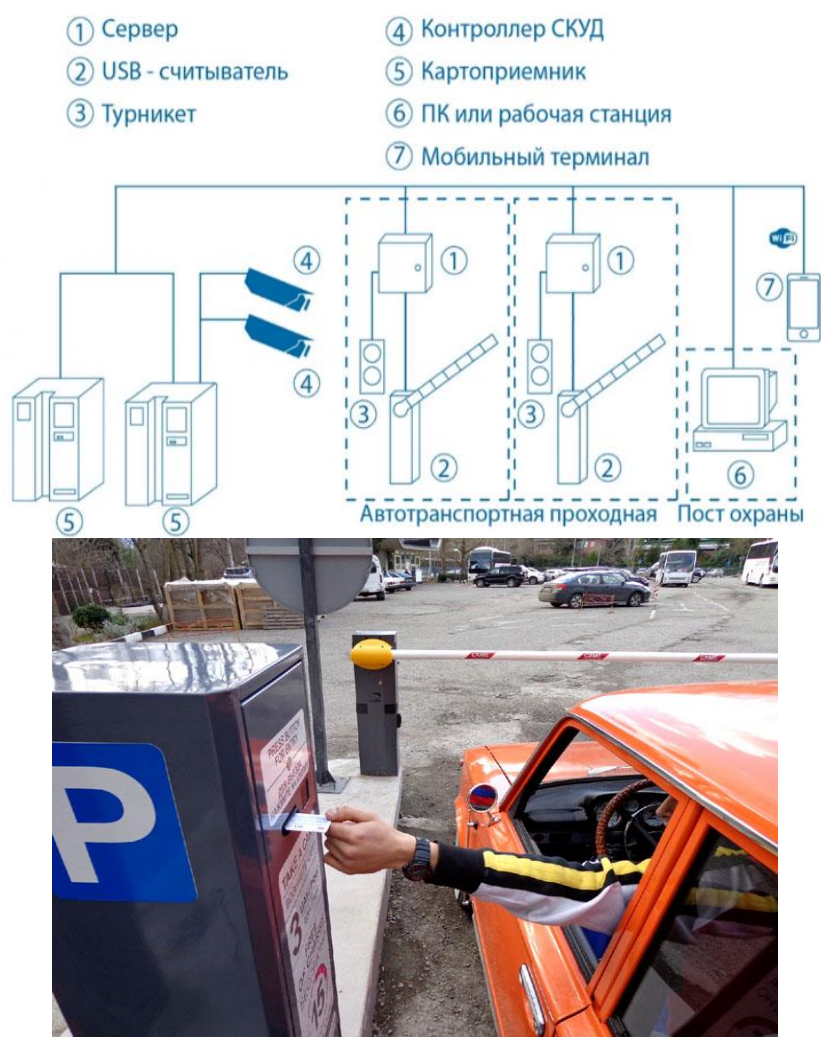
Рис. 6. Схема оборудования КПП при переоснащении [4]
