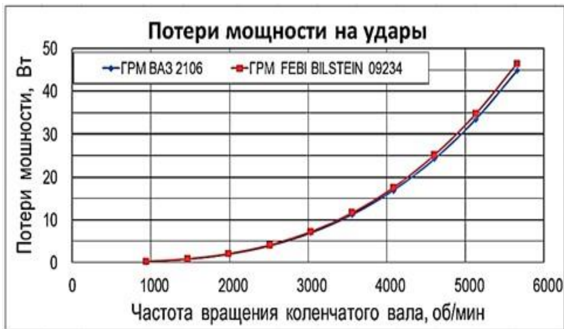
Рис.6. Зависимость от n_{двиг} потерь мощности на удары малой звёздочки по цепи
