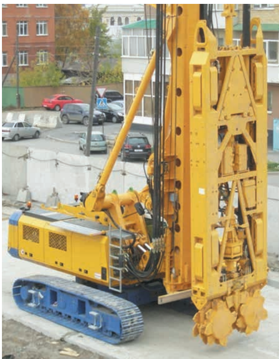
Технологические машины для производства работ по технологии стена в грунте: гидрофреза и телескопический грейфер
