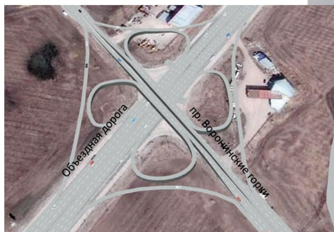
Рис. 4. Имитационная модель организации движения при варианте № 3
