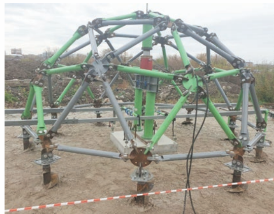
Экспериментальная площадка и установка для испытания свай
