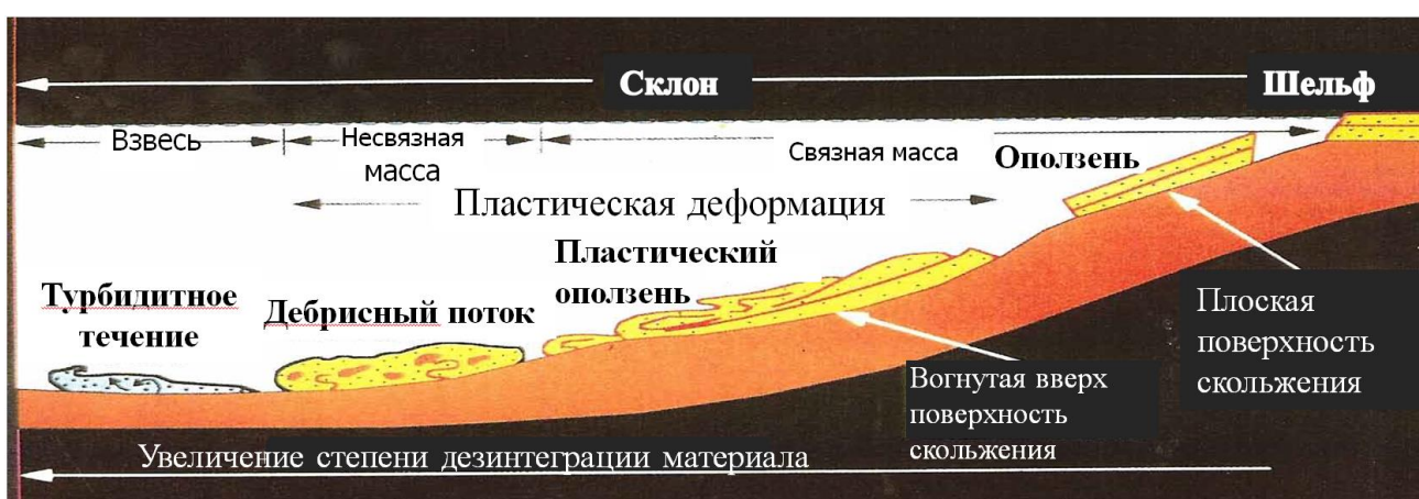
Рисунок 2.2.7 - Схема основных типов процесса гравитационной транспортировки осадков в глубоководных системах (по G. Shanmugam Deep-water process sand facies models: Implications for sandstone petroleum reservoirs: Amsterdam, Elsevier, Handbook of petroleum exploration and production, 2006, v.5)
