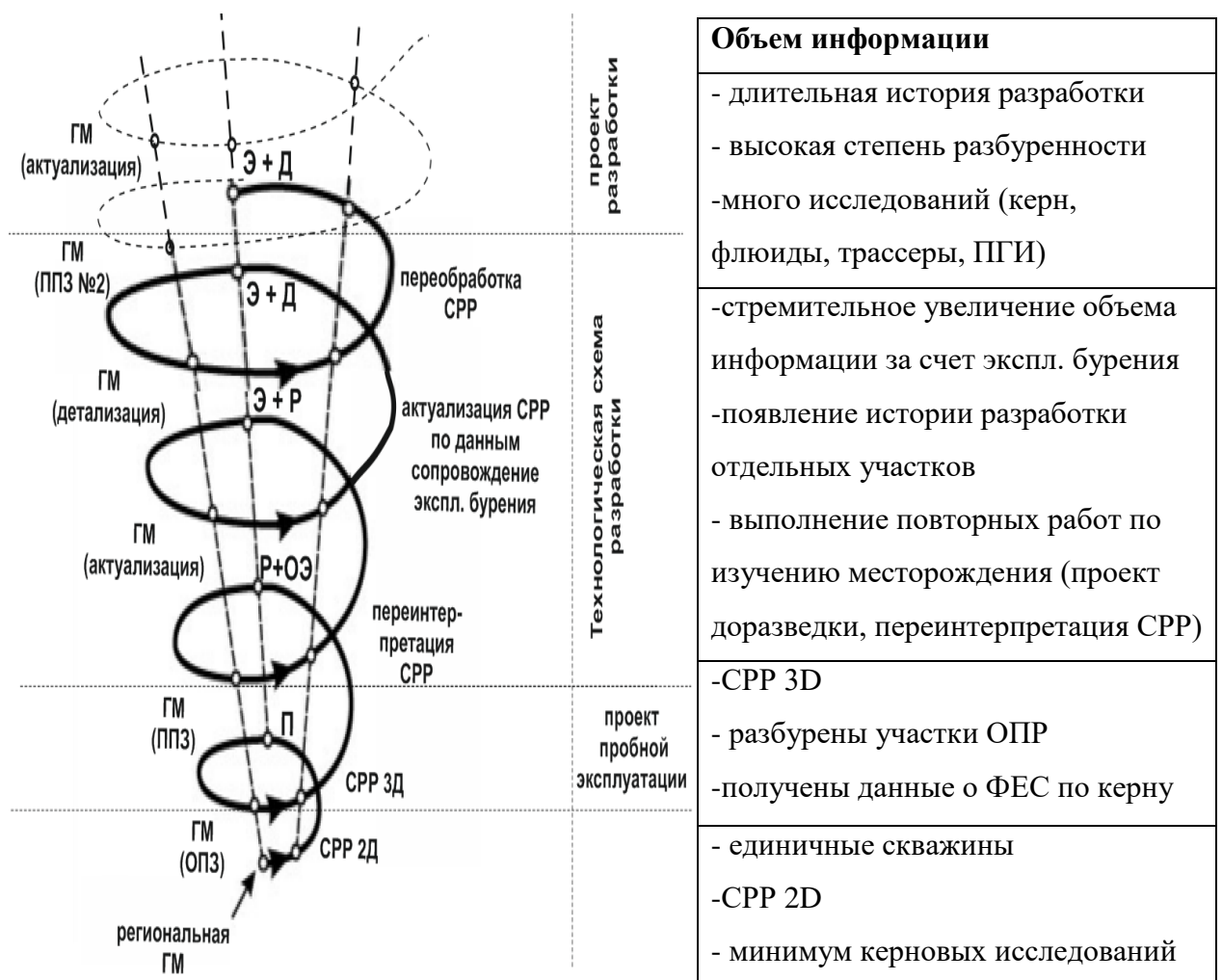
Рисунок 1.4.2 - Схема уточнения геологических моделей по мере увеличения объема геолого-промысловой информации (ГМ – момент обновления геологической модели, П – поисковое бурение, Р+ОЭ – разведочное и опережающее эксплуатационное бурение, Э+Р – эксплуатационное разбуривание и доразведка, Э+Д – эксплуатационное разбуривание и данные о добыче)
