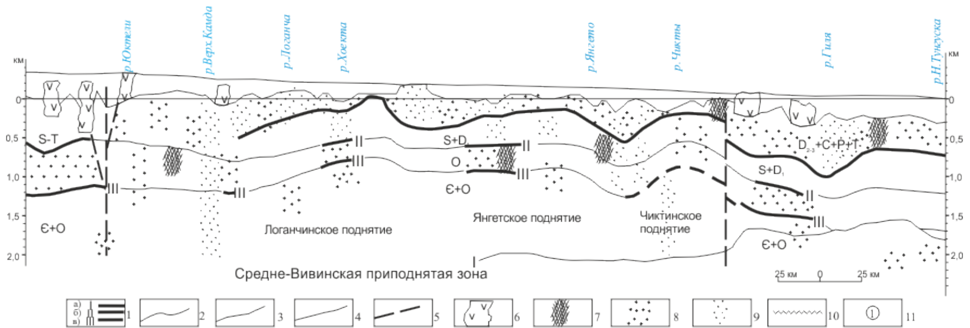
Рисунок 10 – Совмещенный геолого-геофизический профиль вдоль р. Виви (составил В.Н. Бубнов [30])
