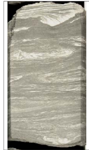
Рисунок 8 - Текстура оплывания, образованная в результате перемещения пластичного слоистого песчано-глинистого осадка. Ем-Еговская площадь, скв. № 30034р, пласт ВК 2 , инт. 1510,40-1510,55 м.
