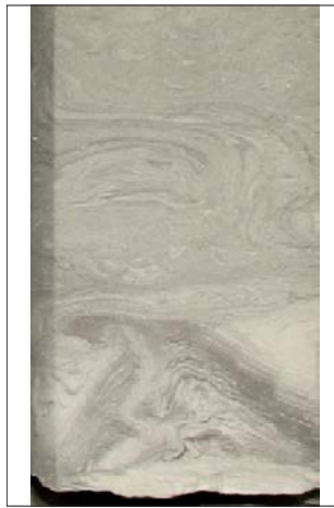
Рисунок 7 - Текстура конседиментационной деформации, развитая во время отложения алевритопесчаного осадка (конволютная слоистость, возможно оползание). Ем-Еговская площадь, скв. № 30034р, пласт ВК 1 , инт. 1496,65 - 1496,80 м.
