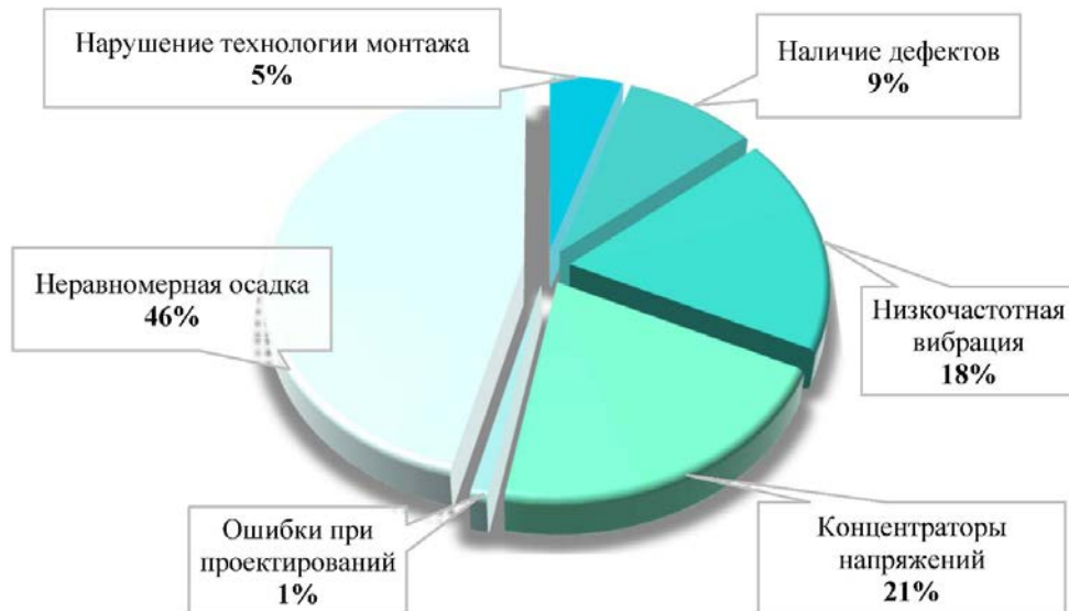
Рисунок 1.1 - Основные причины разрушения вертикальных стальных резервуаров согласно [82]
