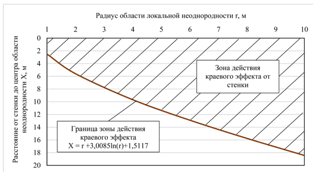
Рисунок 3.23 - Граница зоны действия краевого эффекта от стенки резервуара при толщине днища \delta = 9 мм
