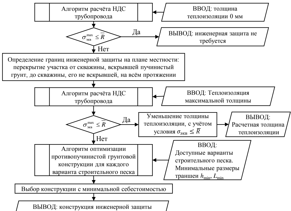
Рисунок 4.15 - Методика расчётного обоснования конструктивных решений магистрального трубопровода с отрицательной температурой продукта на потенциально-опасных участках морозного пучения
