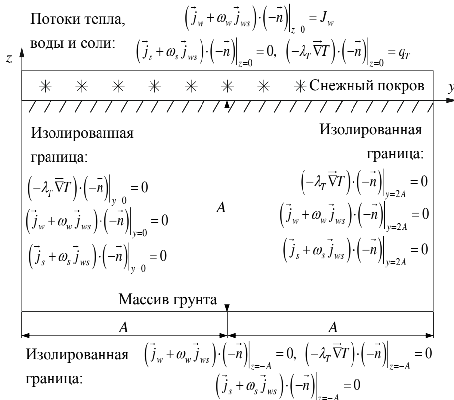
Рисунок 3.4 - Схема для расчета естественного температурно-влажностного режима грунта
