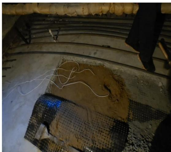
**Рисунок 4.11.** Установка датчиков давления на контактной поверхности «фундамент – грунтовое основание»
