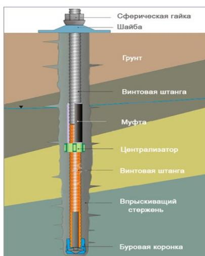
**Рисунок 1.3.** Устройство буроинъекционной сваи [71]
