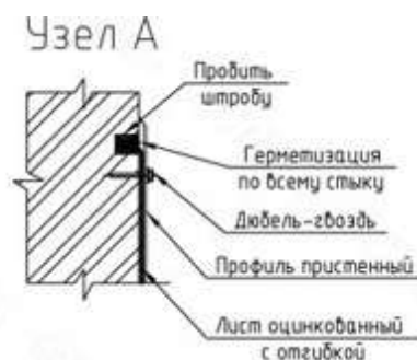
Рисунок 3. Шахта вытяжная вентиляционная утепленная
