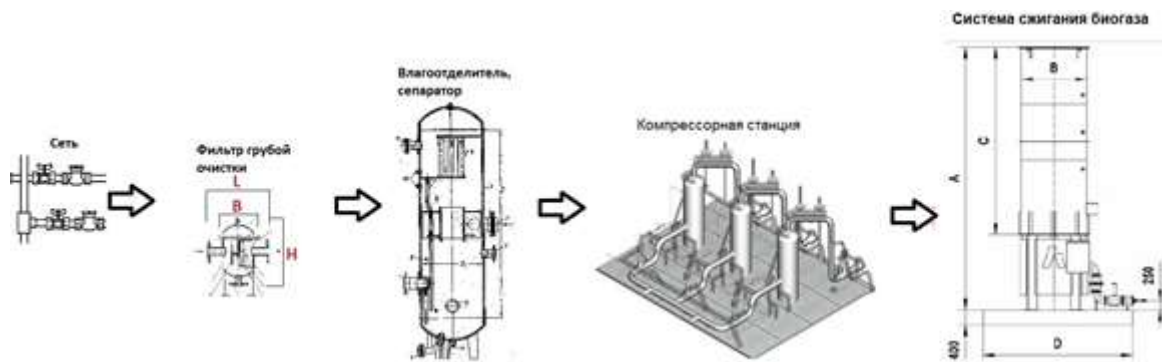
Рисунок 2. Блок схема сжигания биогаза
