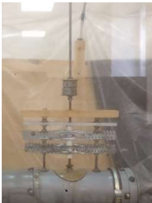
Рисунок 2. Фотография ударного клапана экспериментальной лабораторной установки
