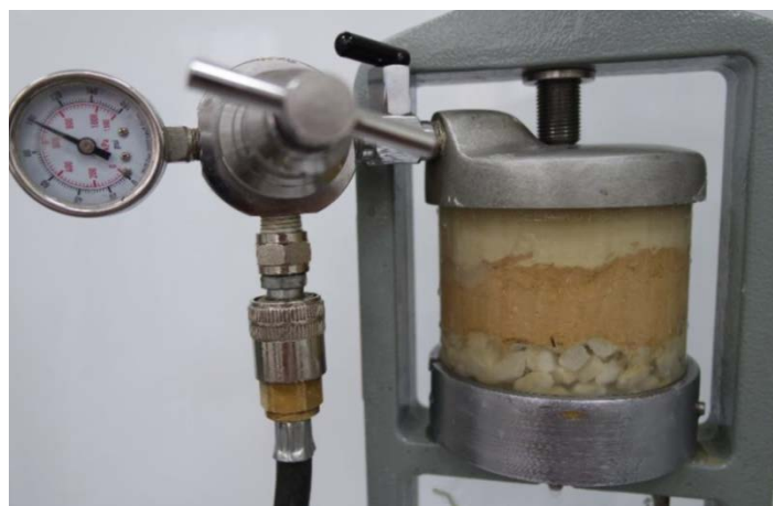
Рисунок 1 – Процесс формирования пробки в лабораторных условиях
