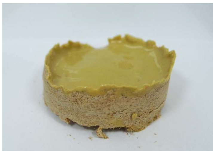
Рисунок 2 – Сформированная пробка состава ULTRA BLOCK
