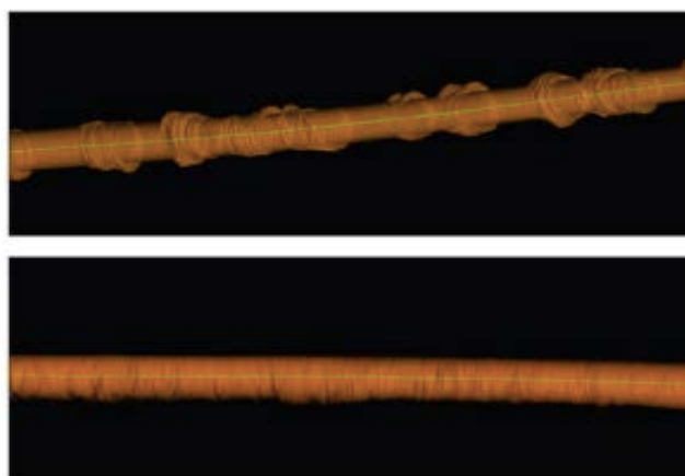
Рисунок 1 – Сравнение качества скважины, построенной по данным кавернометра: сверху – забойный двигатель с кривым переводником, снизу – роторная управляемая система
