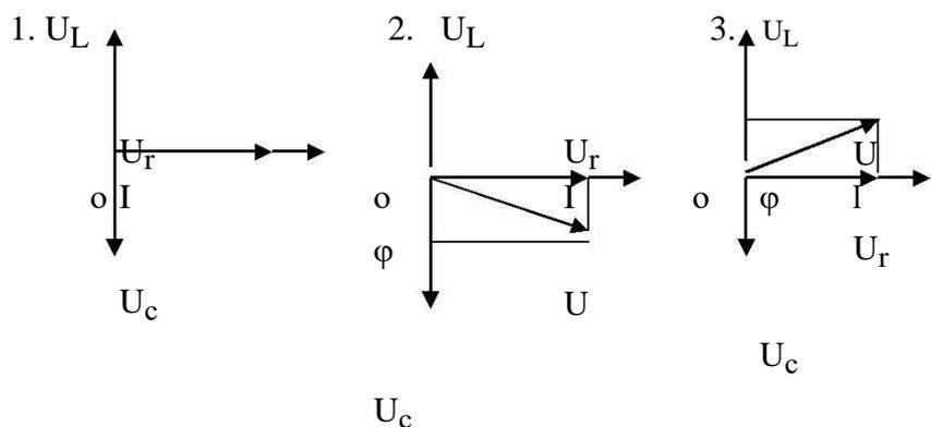
**35. Чему равны напряжения на конденсаторе и катушке индуктивности при резонансе?**
