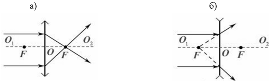
Рис. 4. Действие линз и их условное обозначение
