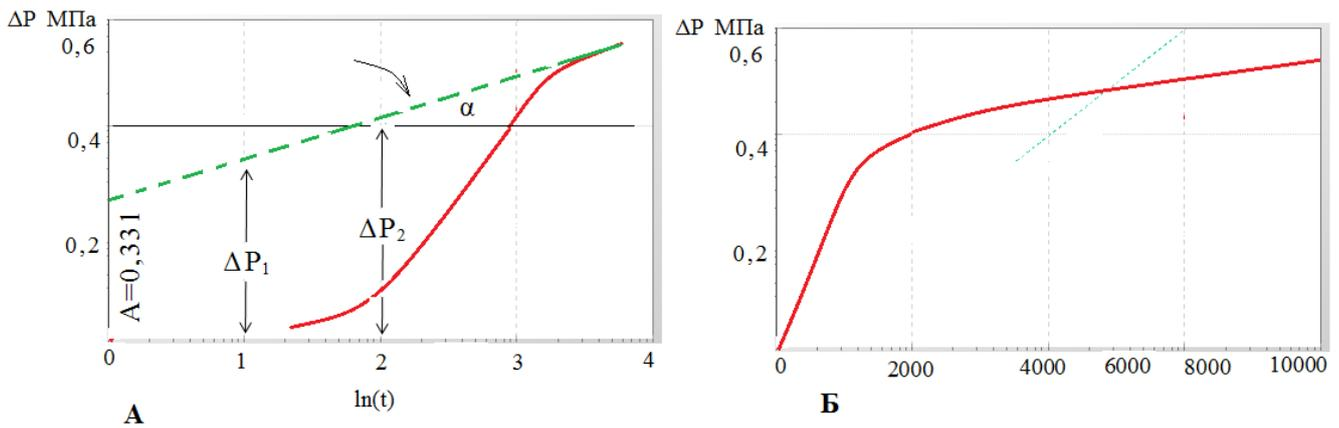
Рисунок 5.1 –Пример обработки К. В. Д. по нефтяной скважине
