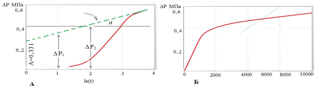
Рисунок 3.1 –Пример обработки К. В. Д. по нефтяной скважине
