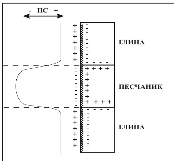
Рисунок 5.1 – Диффузионно-адсорбционные потенциалы при записи ПС
