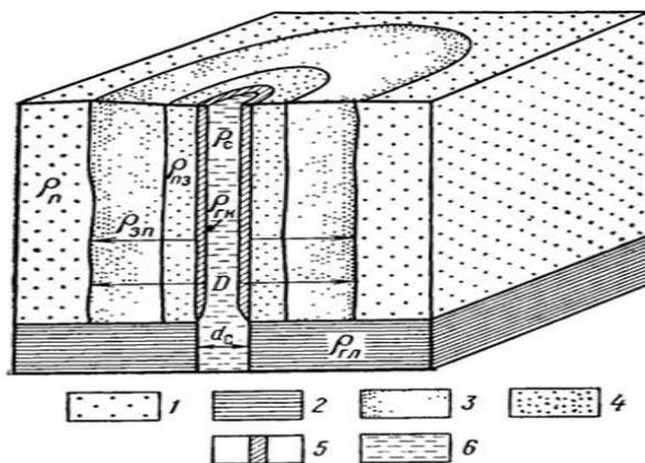
Рисунок 4.1 - Схема радиального распределения сопротивления в проницаемом водоносном пласте смежзерновой пористостью, вскрытого скважиной:
