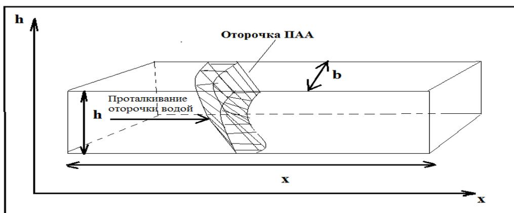
Рис. 6.1. Схема вытеснения нефти из пласта оторочкой полимерного раствора
