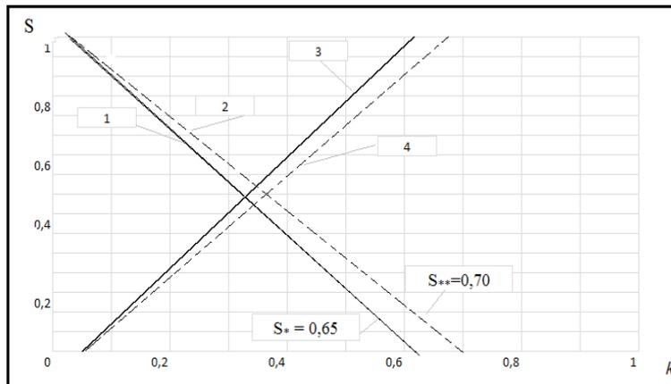
Относительная проницаемость: 1 – для нефти при вытеснении ее водой; 2 – для нефти при вытеснении ее водным раствором полиакриламида; 3 – для воды; 4 – для водного раствора ПАВ
