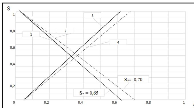
Рис. 5.1. Зависимость относительных проницаемостей  $k$  для нефти и воды, а также для нефти и водного раствора ПАВ от водонасыщенности  $s$ . Относительная проницаемость: 1 – для нефти при вытеснении ее водой; 2 – для нефти при вытеснении ее водным раствором ПАВ; 3 – для воды; 4 – для водного раствора ПАВ
