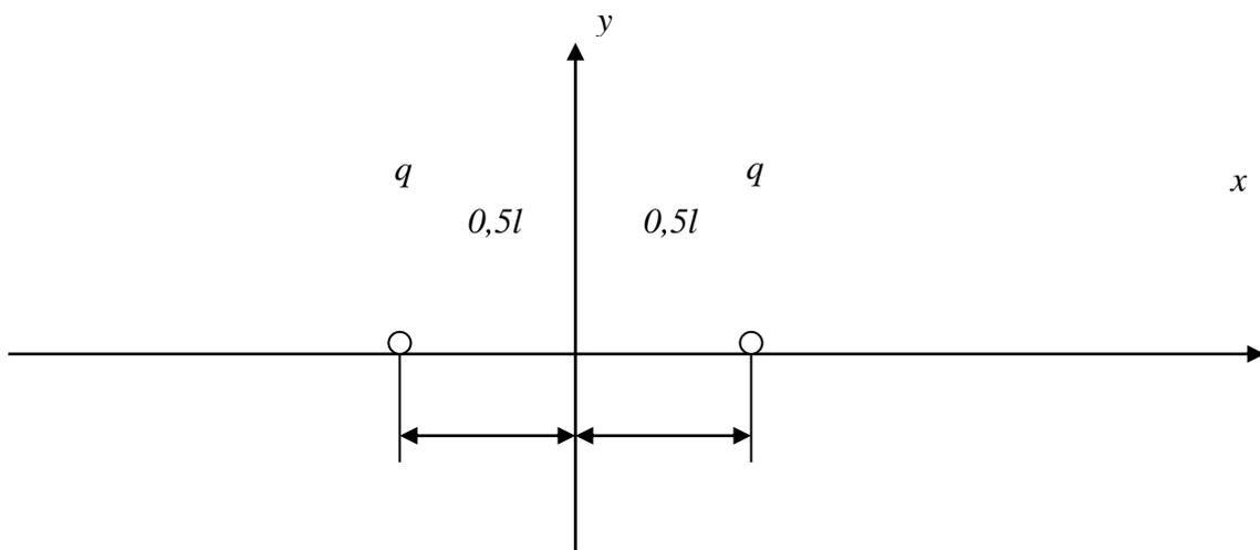
Рис. 3.1. Схема расположения двух скважин в бесконечном по протяженности пласте
