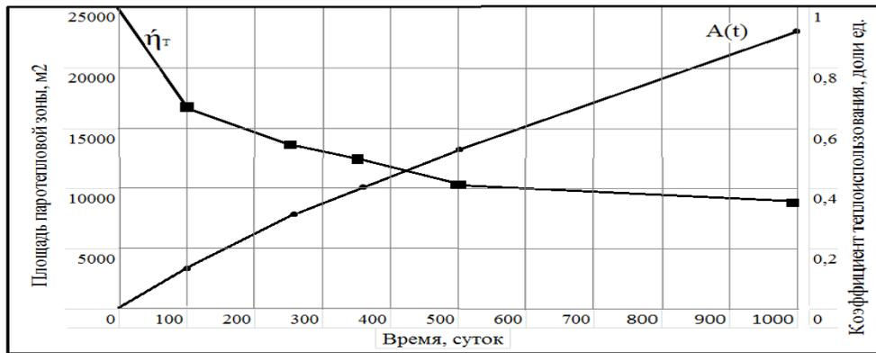
Рис. 7.1. Динамика площади прогреваемой зоны  $A(t)$  и коэффициента теплоиспользования ( $\eta_t$ )
