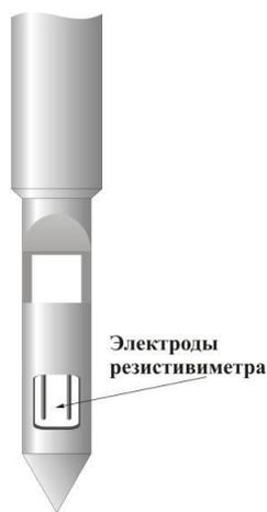
Рисунок 7 – Токовый резистивиметр прибора К-3
