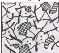
Рис.7 Схема микроструктуры ферритно-перлитного серого чугуна.
