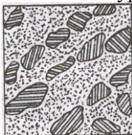
Рис.2 Схема микроструктуры доэвтектического белого чугуна
