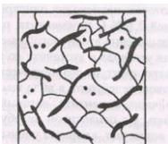
Рис. 5 Схема микроструктуры белого чугуна.
