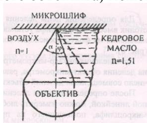
Рис. 4 Влияние коэффициента преломления среды на ход световых лучей в сухом и иммерсионном объективе
