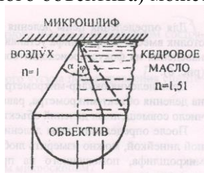
Рис. 4 Влияние коэффициента преломления среды на ход световых лучей в сухом и иммерсионном объективе
