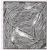
Рис.6 Схема микроструктуры заэвтектического перлитного серого чугуна
