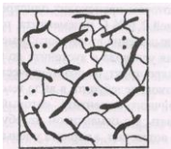
Рис. 5 Схема микроструктуры белого чугуна.
