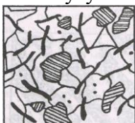
Рис.7 Схема микроструктуры ферритно-перлитного серого чугуна.
