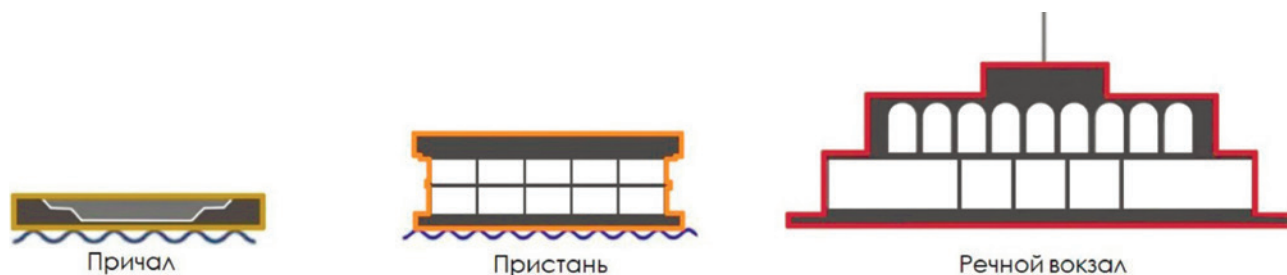
Рис. 1. Типология причальных сооружений
