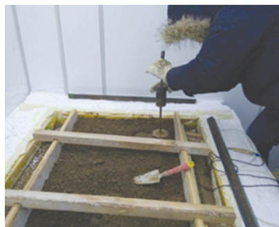
Моделирование условий Крайнего Севера в лаборатории вуза. Экспериментальное исследование маломасштабной модели земляного полотна автомобильной дороги на многолетнемерзлых грунтах
