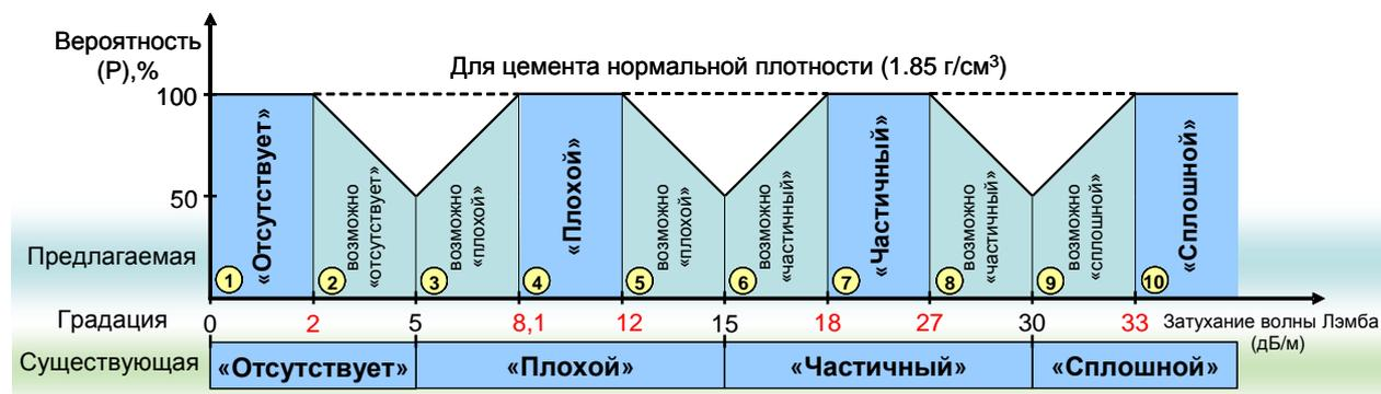
Рисунок 2 – График функции вероятности классификации типа контактов цемент- колонна на классы
