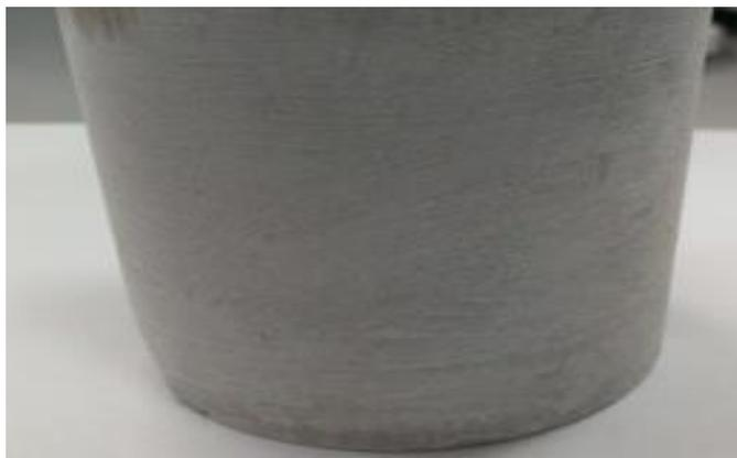
Рисунок 2 – Образец цементного камня на основе ТТМ после термического воздействия
