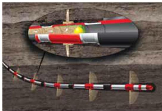
Рисунок 4 – Технология многостадийного гидроразрыва пласта FracPoint™ на ГС с шаров ГРП и раздвижных муфт
