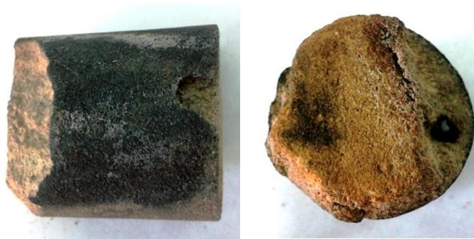
Рисунок 3 – Сквозное отверстие в образце керна
