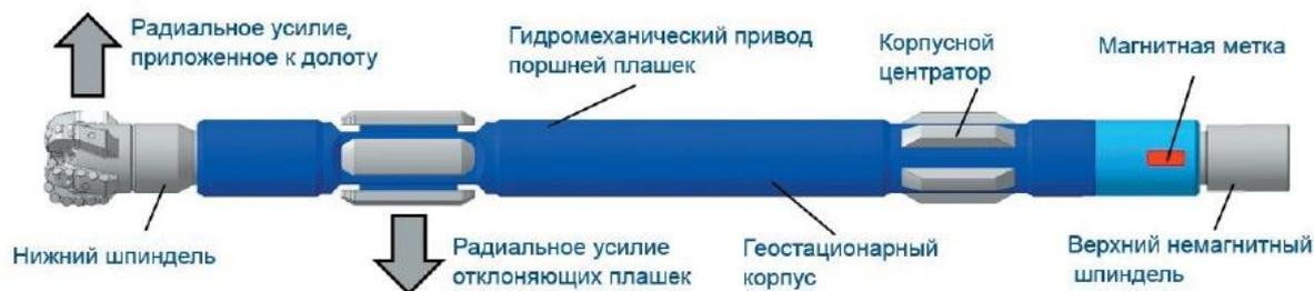
Рисунок 1 – Общая схема роторно-управляемой системы РУС-ГМ
