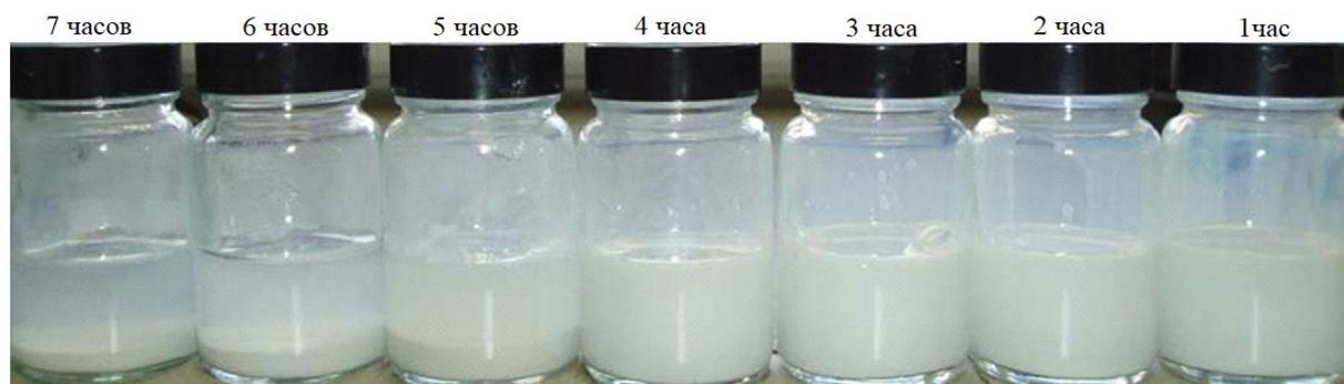
Рисунок 1 – Пример стабильности наножидкостей (без ПАВ) относительно времени
