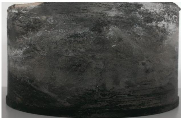
Рисунок 1 – Образец цементного камня на основе ПЦТ I-G после термического воздействия
