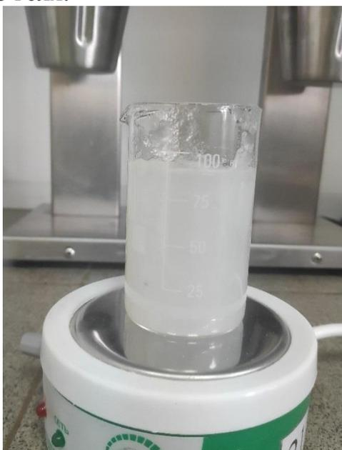
Рисунок 1 – Гель образовывался добавлением 7 % силиката натрия Монасил и 7,7 % лимонной кислоты
