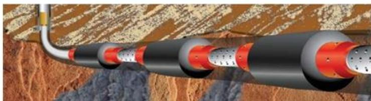
Рисунок 1 – Технология МГРП для сегментированной адресной добычи на скважинах ВНС
