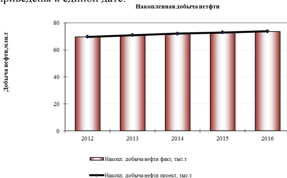
Рисунок 1 – Сравнение проектных и фактических накопленных отборов нефти и жидкости, объект БС10
