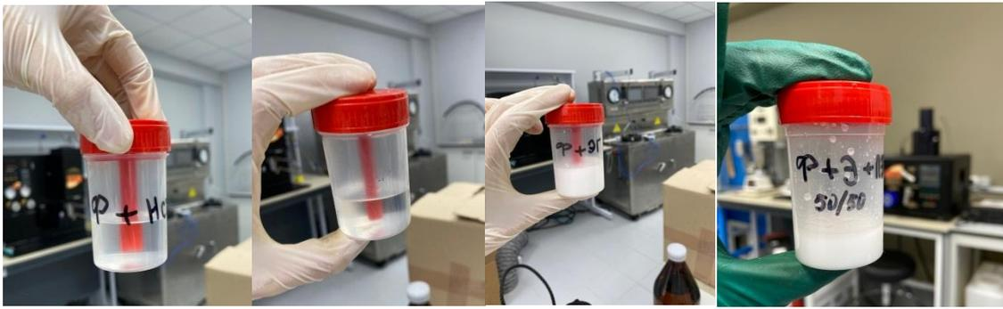
Рисунок 5 – Смешивание фторкетона со спиртами
