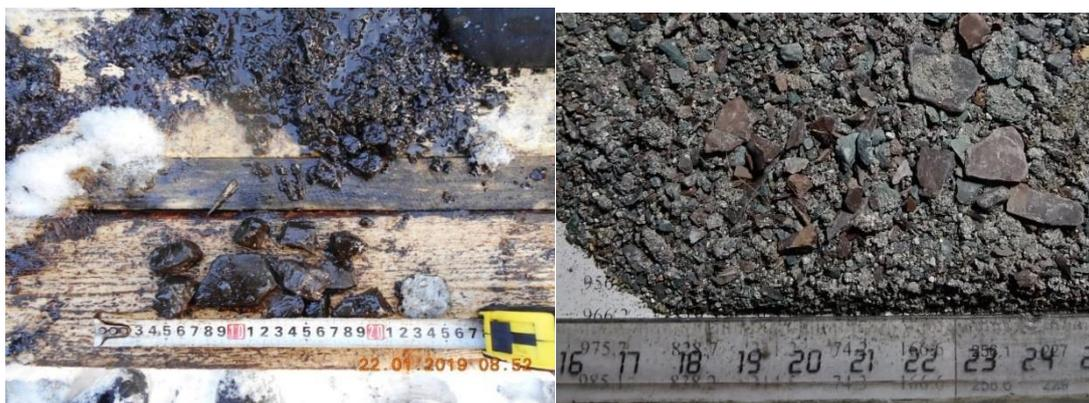
Рисунок 3 – Выход шлама из скважины при промывке
