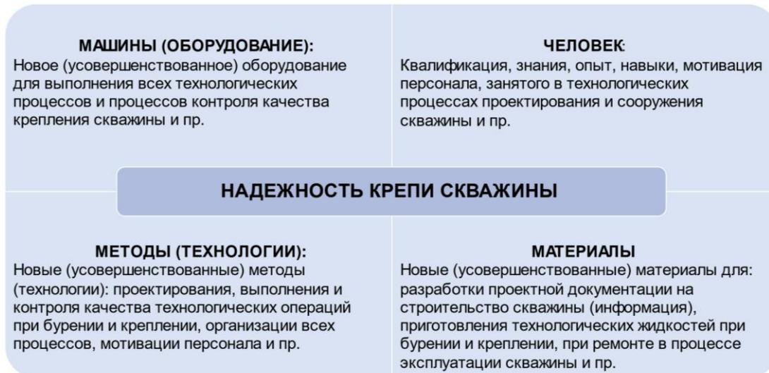
Рисунок 2 – Группы факторов обеспечения надежности крепи скважины
