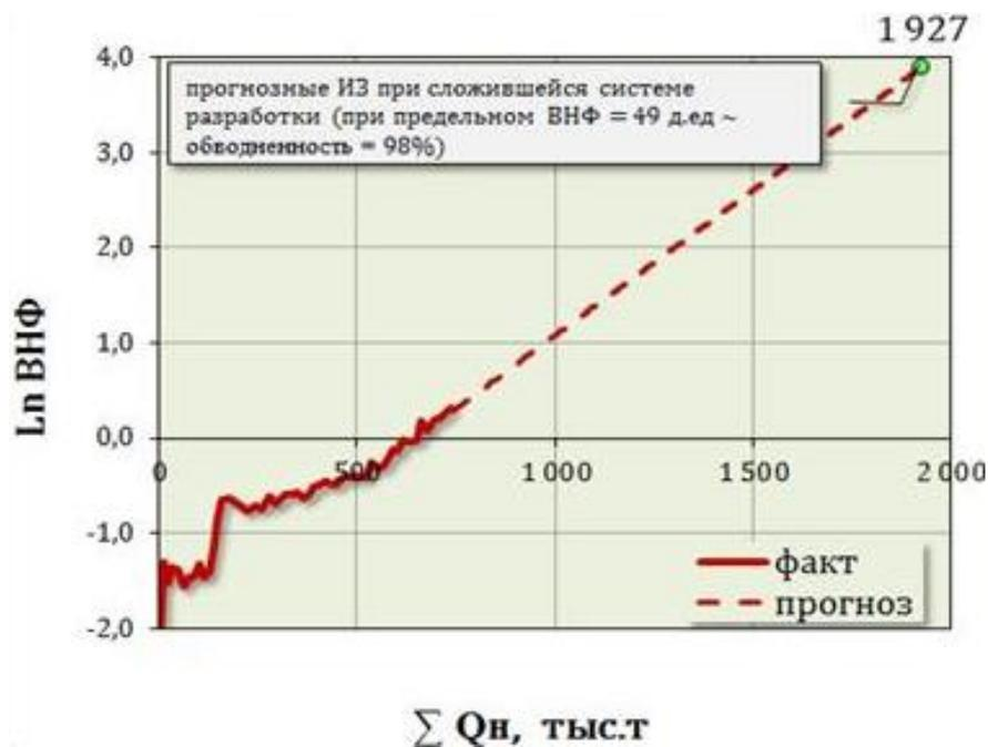
Рисунок 3.2 – Зависимость  $\ln(\text{ВНФ}) - \Sigma Q_n$  (график из ЛНД)
