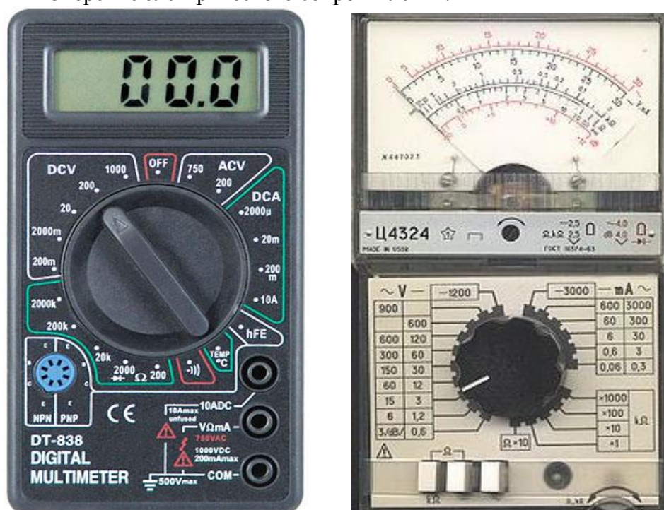
Рис. 2.1. Цифровой и аналоговый мультиметры
