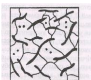
Рис. 5 Схема микроструктуры белого чугуна.
