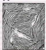
Рис.6 Схема микроструктуры заэвтектического перлитного серого чугуна
