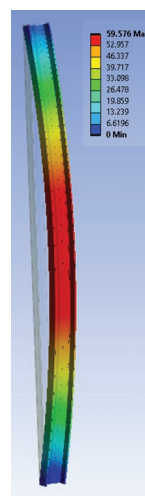
Рис. 6. Результаты эксперимента: а) деформации; б) нормальные напряжения
