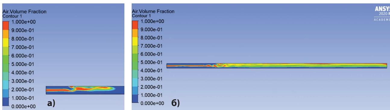
Рис. 5. Контур распределения объемной доли газа в горизонтальном трубопроводе:
