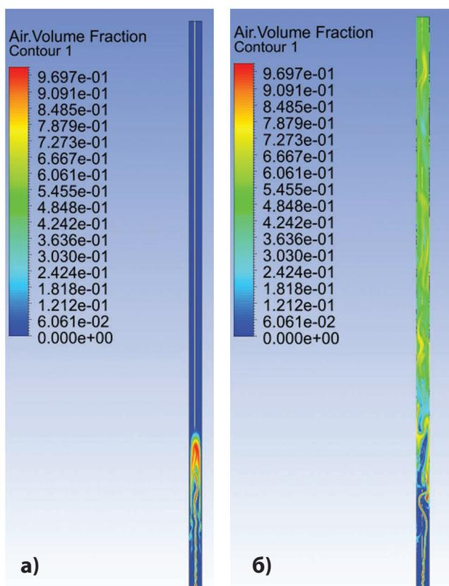
Рис. 4. Контур распределения объемной доли газа в вертикальном трубопроводе:
