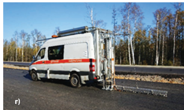
Рис. 1. Оборудование для оценки прочности дорожных одежд автомобильных дорог: а) длиннорычажный рычажный прогибомер; б) установка динамического нагружения «Дина-4»; в) установка «ДИП Импульс»; г) универсальный диагностический комплекс типа «УДК»
