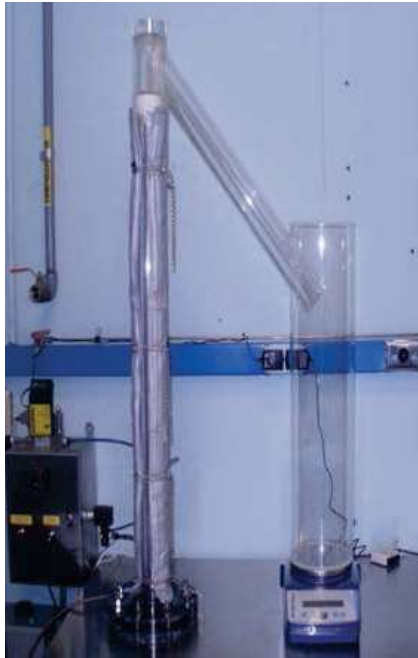
Рис. 3. Фото установки для определения безразмерного коэффициента U_{lrss}/U_{sgss}
