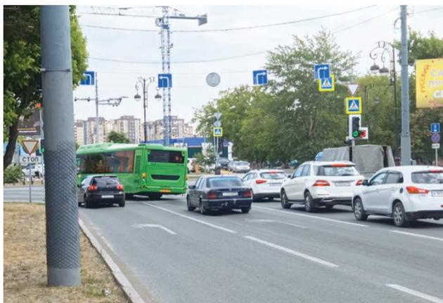
Рис. 5. Разметка 1.18, нанесенная перед перекрестком улиц М. Тореза и Республики в г. Тюмени
