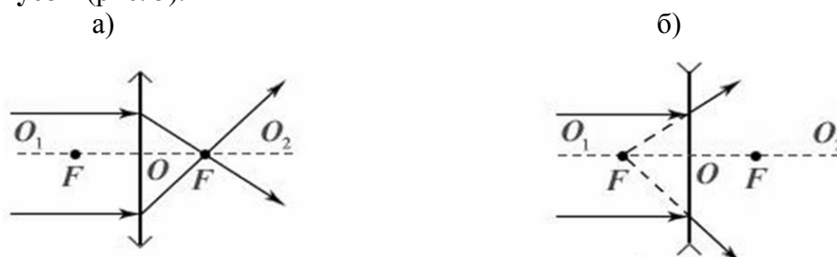
Рис. 4. Действие линз и их условное обозначение
