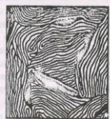
Рис.6 Схема микроструктуры заэвтектического перлитного серого чугуна
