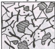
Рис.7 Схема микроструктуры ферритно-перлитного серого чугуна.
