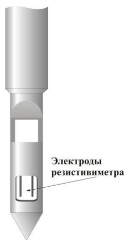
Рисунок 7 – Токовый резистивиметр прибора К-3
