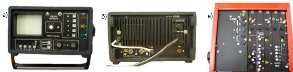
Рисунок 3.5 - Электронный блок УД2-12: а – электронный блок; б) – электронный блок, вид сзади; в) – настроечная панель.
