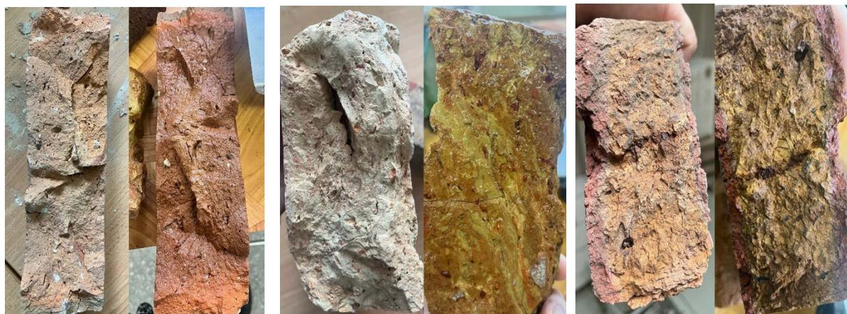
Рисунок 2 – Образцы, высушенные до постоянной массы и после насыщения водой в течении 48 часов
