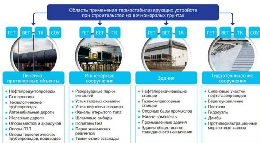
Рисунок 1 – Область применения термостабилизирующих устройств
