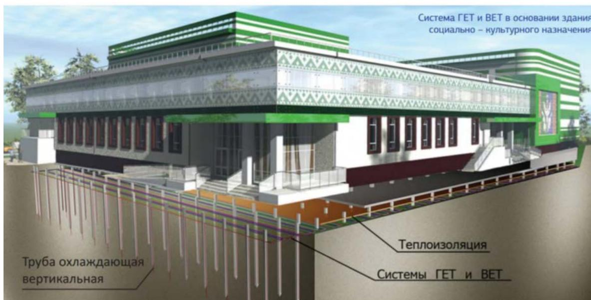
Рисунок 2 – Системы ГЕТ и ВЕТ в основании здания
