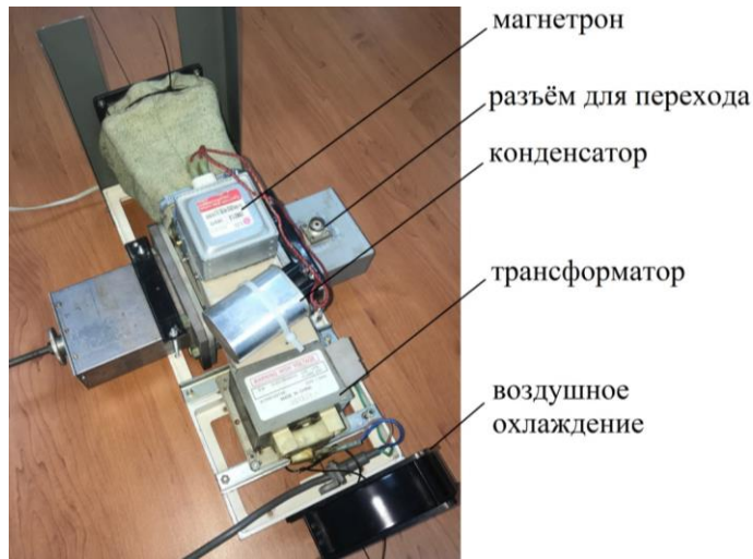
Рисунок 8 – СВЧ установка и её составляющие
