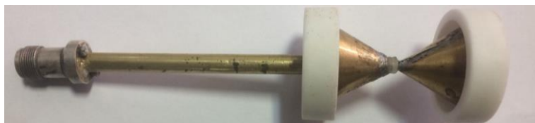
Рисунок 6 – Биконический рупорный СВЧ излучатель
