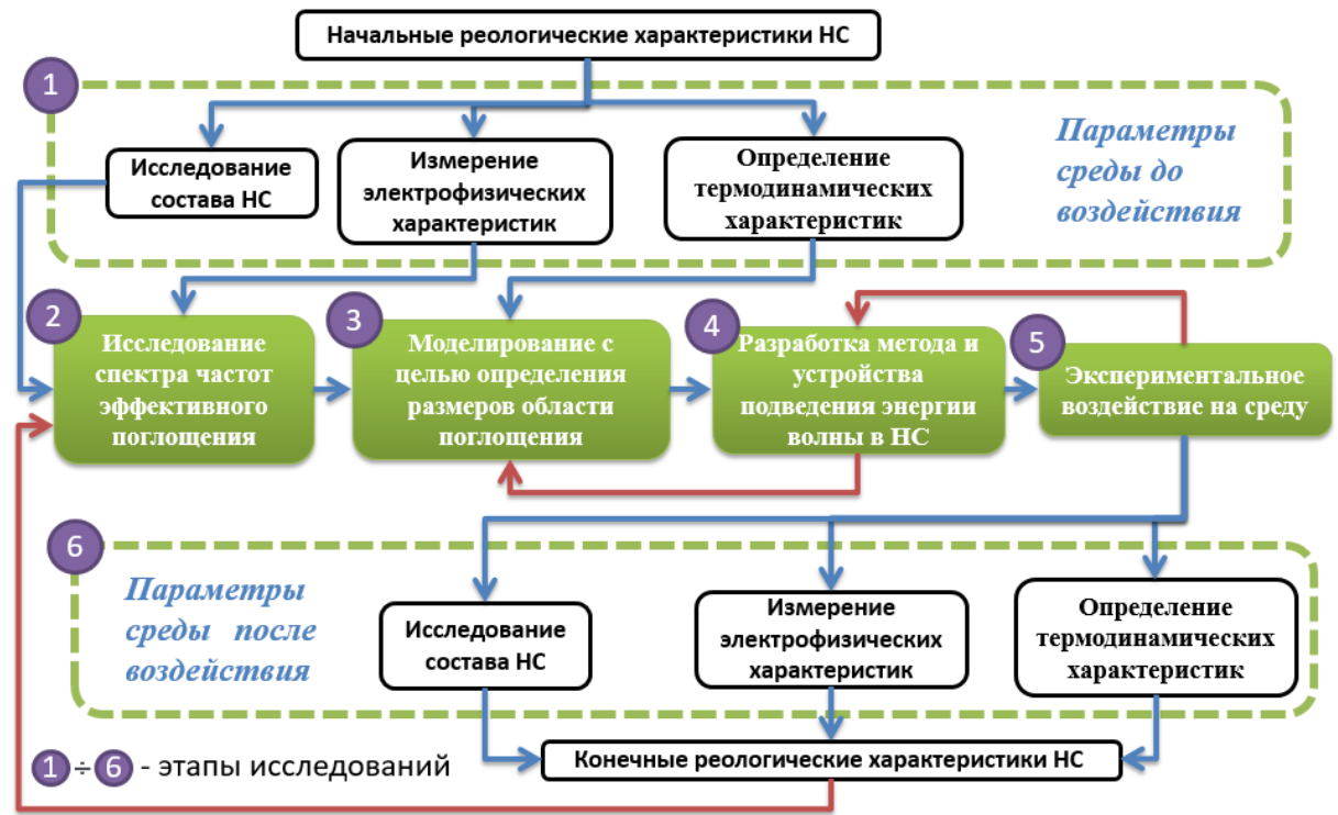
Рисунок 8 – Схема связанных исследований волнового воздействия на НС
