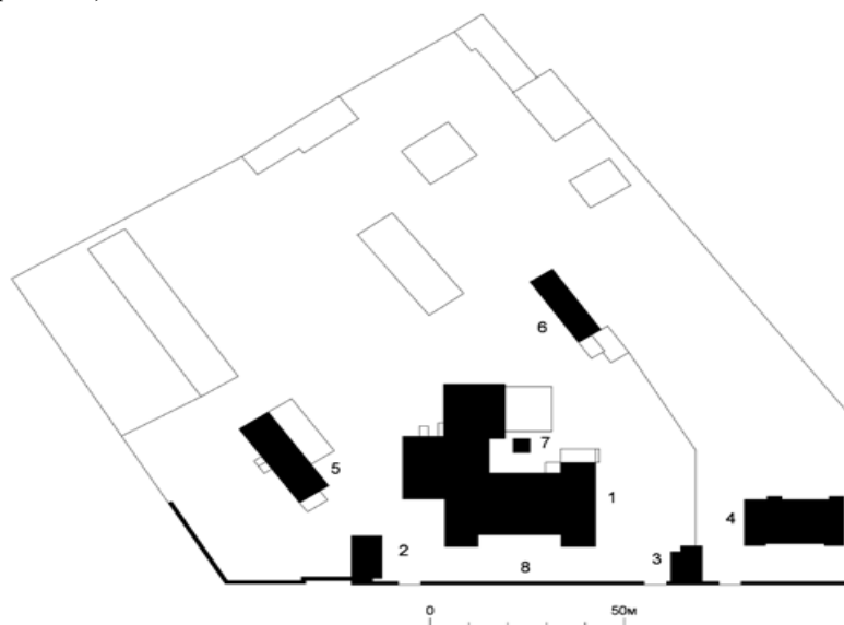
Рисунок 1 – План-схема казенного винного склада: 1. Главный корпус; 2-3. Сторожки; 4. Жилой дом; 5. Помещение для цистерн; 6. Бондарная; 7. Труба котельной; 8. Ограда
