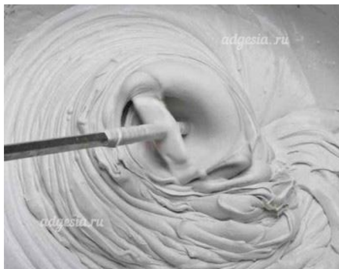
Рисунок 2 – Бетонная смесь с добавлением латекса
